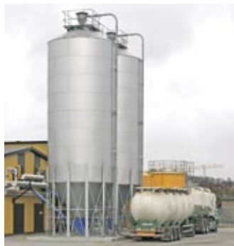
Ein Schüttguttransporter fasst 12 Tonnen Pellets, mit Anhänger sogar 32 Tonnen Pellets.
