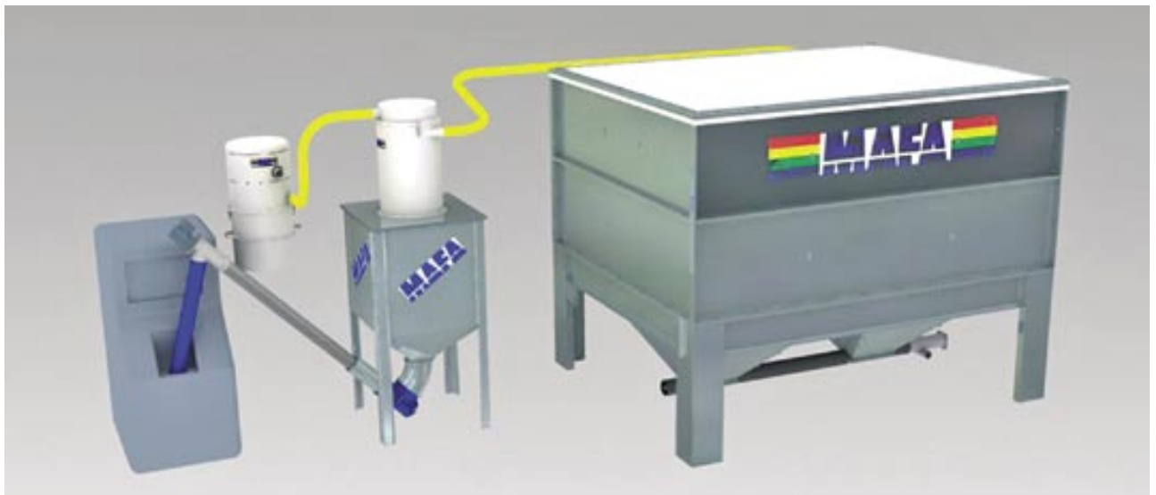
MAFA Systemlösung mit einem MAFA Villa 345S in Kombination mit MAFA MaVac Vakuumtransport für die beförderung von Pellets bis zu 45 Meter zum Brenner/Kessel über ein MAFA Mini als Zwischenlager.
