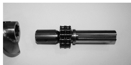
Drivtappen är försedd med dubbelkedja som eliminerar oönskad kraftpåverkan på motor/växel.
