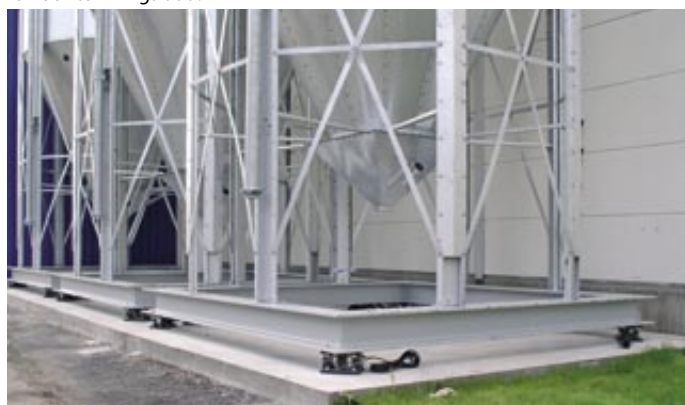
MAFAs silos kan kompletteras med ett vågsystem som ger exakt kontroll över inleveranser, lagerstatus och utgående materialflöden.
