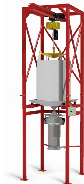
BAGBOY HYGIEN Gen. II typ C Traversstativ (10c) med säckstöd (4b), eldriven kättingtelfer (17) och lyftok (18a). Klämenhet (21) för fixering och sträckning av tömningsstos, styrd från ett pneumatiskt styrskåp (20).
