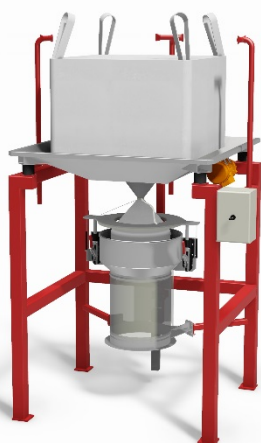
BAGBOY HYGIEN Gen. II typ A Golvstativ (10a) med säckstöd (4b) och centreringsarmar (1a). Klämenhet (21) för fixering och sträckning av tömningsstos, styrd från ett pneumatiskt styrskåp (20).
