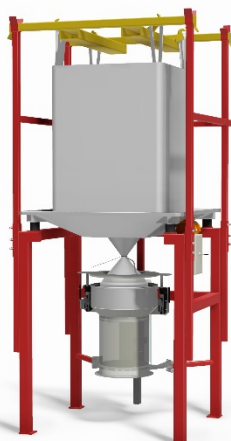
BAGBOY HYGIEN Gen. II typ B Golvstativ (10b) med säckstöd (4b), säckupphängningsstativ (1b) och ok för truck eller kran (18c). Klämenhet (21) för fixering och sträckning av tömningsstos, styrd från ett pneumatiskt styrskåp (20).
