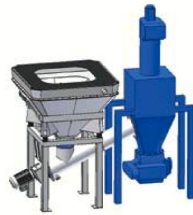
Filter och cellmatare
