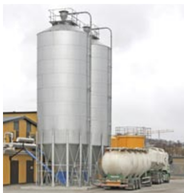
En tankbil rummer ca. 12 tons træpiller på en forvogn og ca. 30 tons med anhænger.
